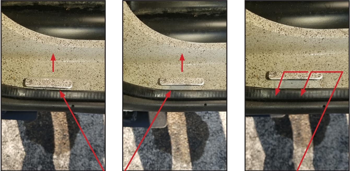
**ROLLER GUIDE ADJUSTMENT ON SINGLE DOORS. GAP THE DOOR FRAME'S TOP AND BOTTOM ROLLER GUIDE AWAY FROM THE DOOR GASKET SO THE DOOR WILL MAINTAIN CONSTANT PRESSURE WHEN CLOSED.**
