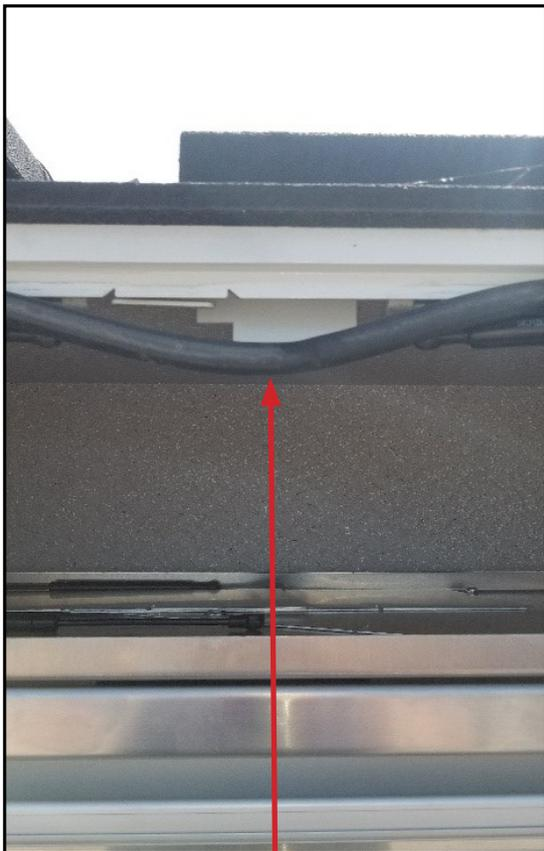
**TOP PORTION OF DOOR GASKET PULLED DOWN TO MAKE CLEARANCE TO CUT WITH SHEARS.**
